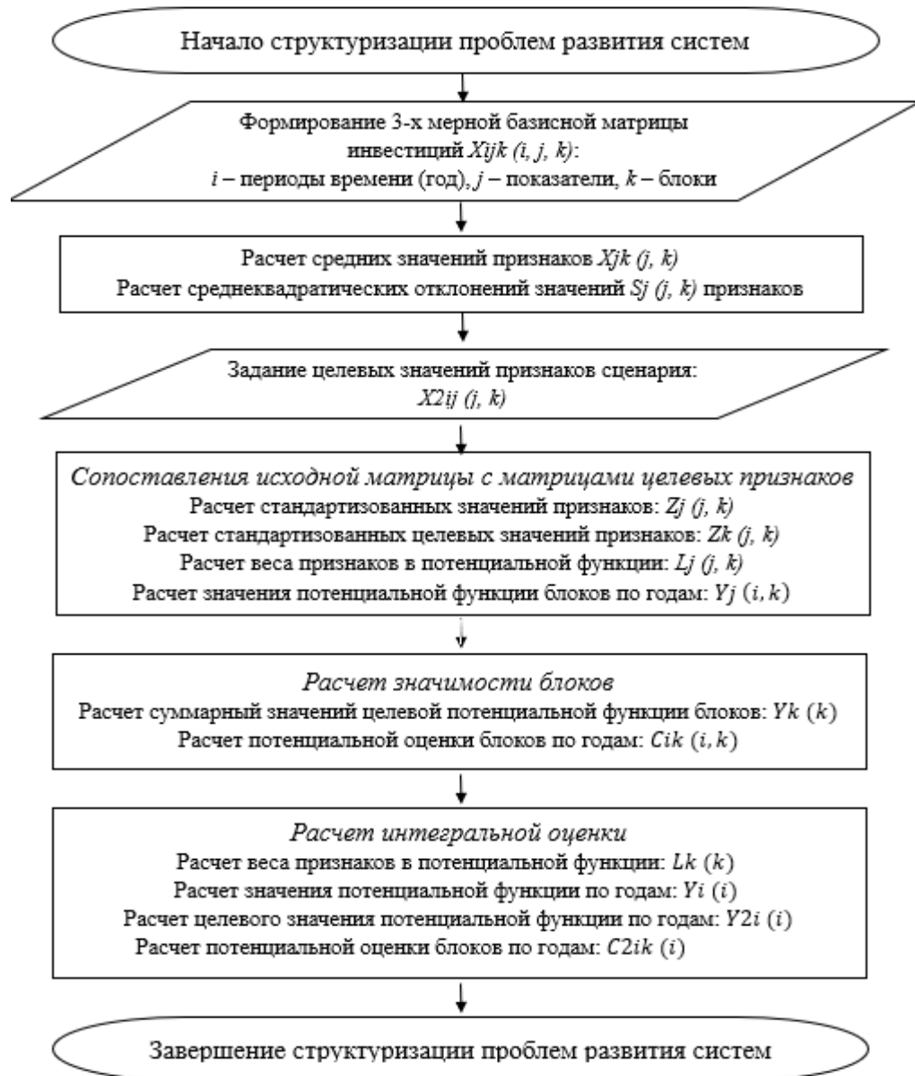
Рисунок. X.1. – Алгоритм моделирования структуризации проблем развития систем
